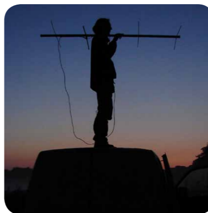
Une antenne couplée à un récepteur permet de suivre les déplacements de la chauve-souris équipée d'un émetteur.
