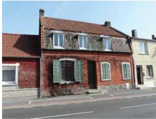
Maisons de bourg se caractérisant par leur deuxième sous comble. Pour laisser aux lucarnes, les toitures ont été aménagées avec un brisis. On les appelle « toit à la Mansard », ou toit à pan brisé.
